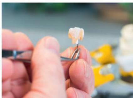
**CZR Zirkonoxidverblendkeramik** ist eine vollsynthetisch hergestellte Zirkondioxidkeramik. Drei verschiedene Körnungsgrößen der synthetischen Bestandteile bewirken beim Aneinanderlagern wesentlich verkleinerte Teilchenzwischenräume. Damit wird die Schrumpfung beim Brennen der Keramik deutlich verringert. Sie überzeugt desweiteren durch überaus hohe Biegefestigkeitswerte und garantiert so den Einsatz im Front- und Seitenzahnbereich.
