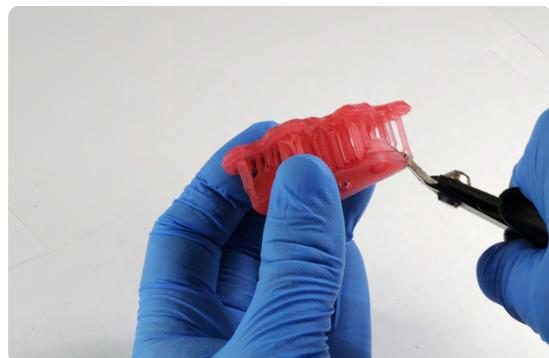
Eine kleine, scharfe Schere kann als zweiter Schritt die Stützstrukturen näher am Druckteil abschneiden.
